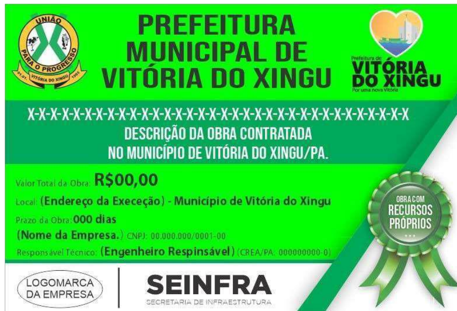
Figura 1 - Placa de obra - H: 2,00 x L: 3,00
