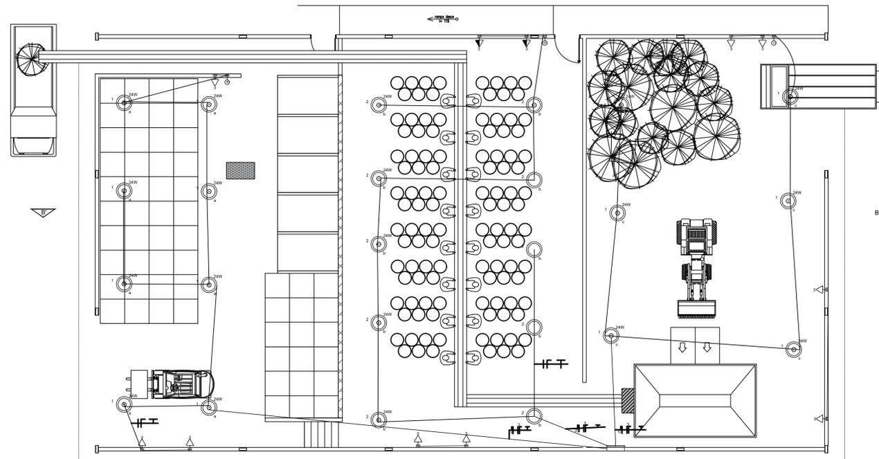
todos os condutores referentes à alimentação de tomadas serão 2,5mm conforme a norma 5410 determina
